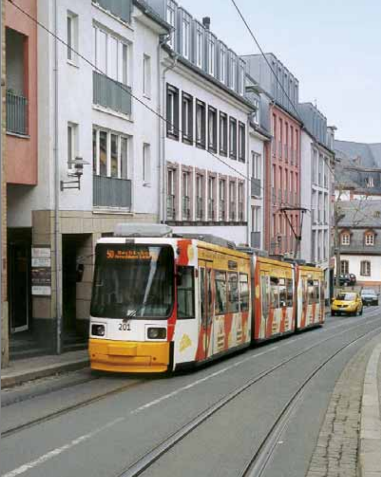
Wagen 203 fährt die Neun-Prozent-Steigung in der Gaustraße hinauf. Trotz dieser Steigung haben die Mainzer Trams keinen Allradantrieb!
